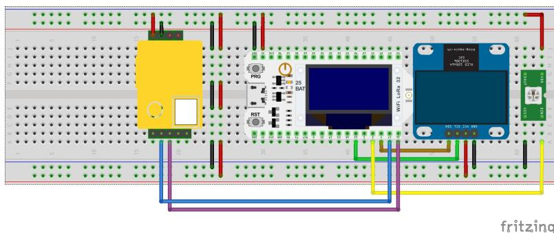
In Textform sind die Verdrahtungsanweisungen dann auch noch im Sourcecode zu finden. Verwendet man das TTGO (Heltec) ESP32 LORA Board, oder Ähnliches, so ist das Display natürlich schon integriert, und man spart sich das separate Display (war bei mir nur separat, weil ich das integrierte gekillt hatte)
