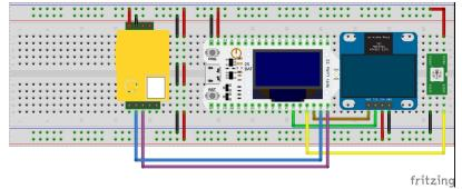
in Textform sind die Verdrahtungsanweisungen dann auch noch im Sourcecode zu finden. Verwendet man das TTGO (Heltec) ESP32 LORA Board, oder Ähnliches, so ist das Display natürlich schon integriert, und man spart sich das separate Display (war bei mir nur separat, weil ich das integrierte gekillt hatte)
